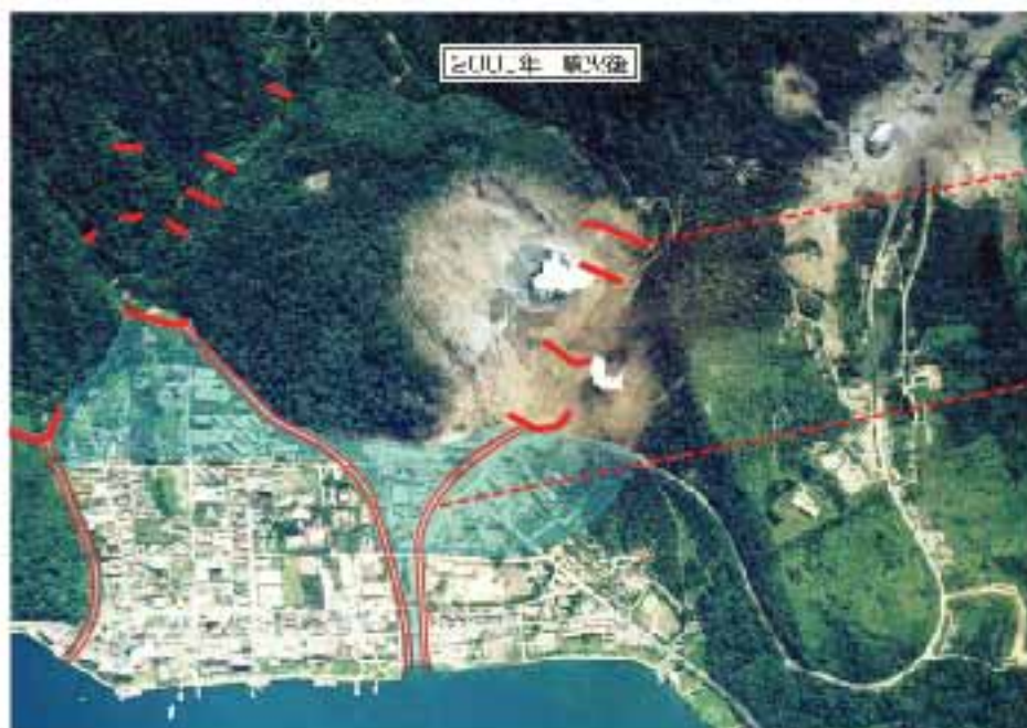
1977年噴火後に作られた砂防施設(赤い線)と2000年噴火後に作られることになった砂防施設の区域(青い範囲)
