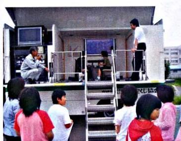
次に案内された地震体験車は、大型トラックの側面が開き、そっくり部屋になっているのですが、横に震度を設定できる機械が取り付けられており、実際に震度〇の体験ができるというしくみです。
